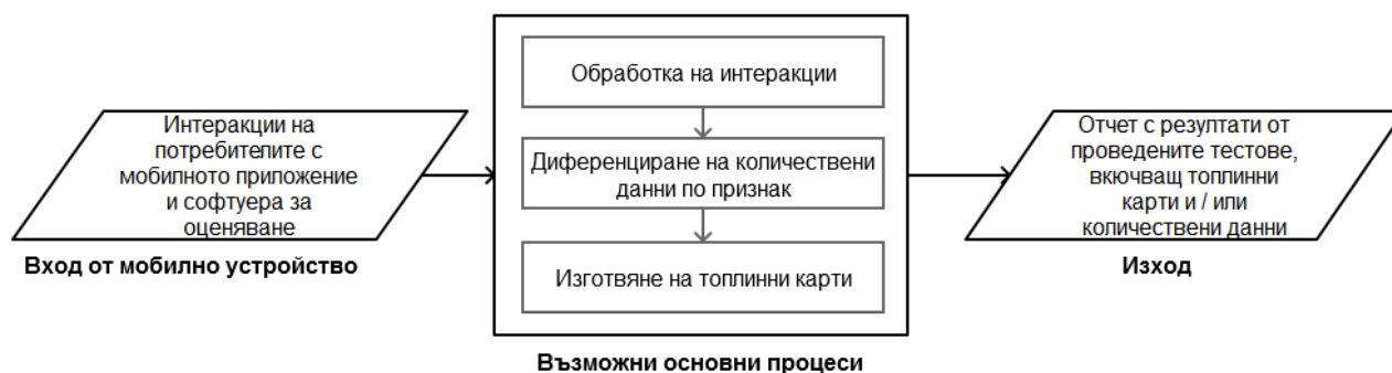
Фиг. 2. Концептуален функционален модел на софтуер за оценяване на мобилни приложения
